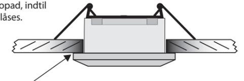
Hvis du vil afmontere armaturet igen, skal du sætte en fastskruetrækker mellem armaturet og loftet.
